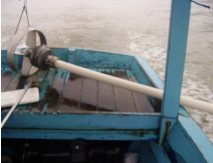
Figura 28. amostrador testemunhador utilizado para coleta de sedimento sub-superficiais.
