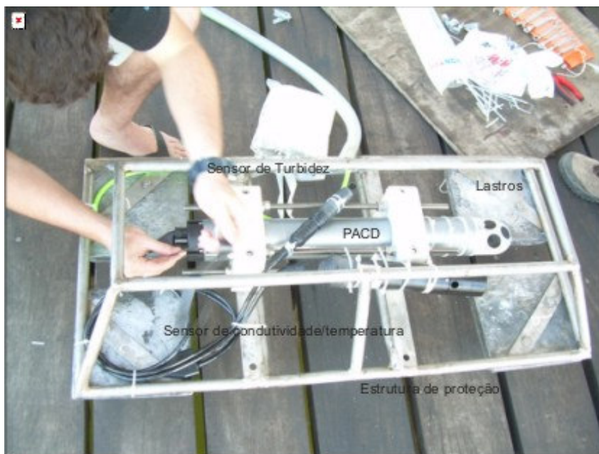
Figura 17: Fotografia do PACD fixo em sua estrutura de proteção.
