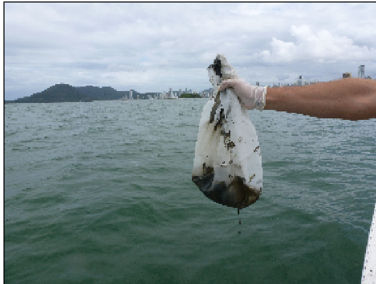
Figura 16. Acondicionamento das amostras em saco tela com abertura de malha de 500 micra.
