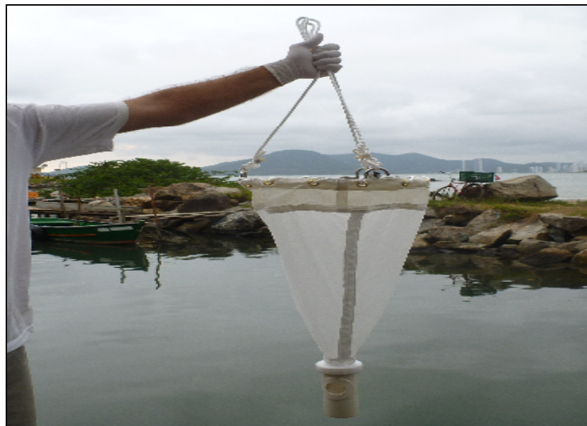
Figura 14. Rede cônica com malha de 20 µm utilizada para amostragem qualitativa de fitoplâncton.
