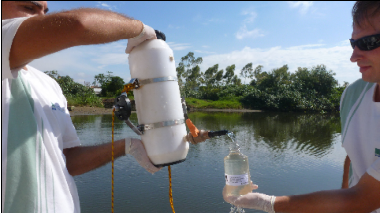
Figura 3. Amostras de água coletada com garrafa amostradora tipo van Dorn sendo acondicionada em frasco de plástico.
