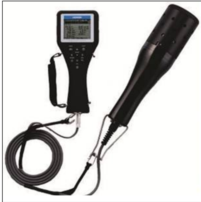
Figura 4. Sonda multiparamétrica marca Horiba, modelo U50, sendo utilizada na mensuração in situ dos parâmetros físico-químicos.
