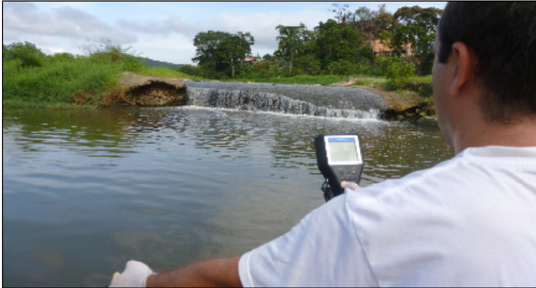
Figura 12. Sonda multiparamétrica marca Horiba, modelo U50, sendo utilizada na mensuração in situ dos parâmetros físico-químicos.
