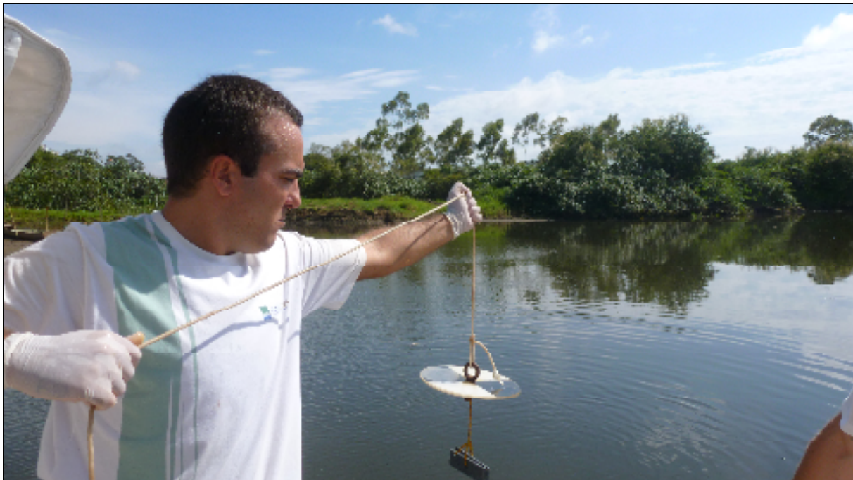
Figura 13. Disco de Secchi sendo utilizado na mensuração da transparência da água.
