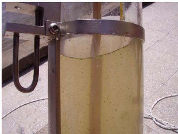
Fig. 5. Botella de Van Dorn conteniendo muestra de agua tomada en el Río de la Plata. Se puede observar la presencia de colonias de cianobacterias visibles a simple vista.
