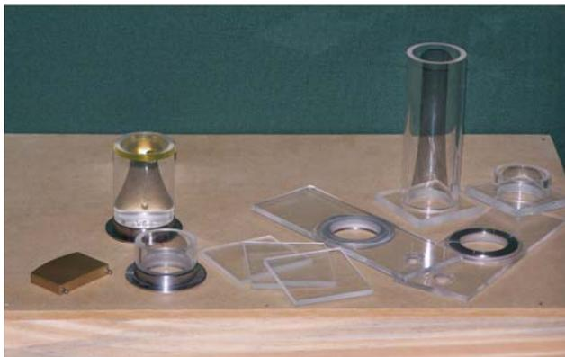
Fig. 8. Cámaras de sedimentación
